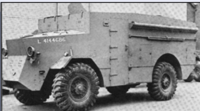
Een Guy Lizard ACV in de fabriek in Wolverhampton. Aan de zijkant zijn de opgerolde tent en de tentpalen bevestigd. De onderste foto toont het interieur van het voertuig
