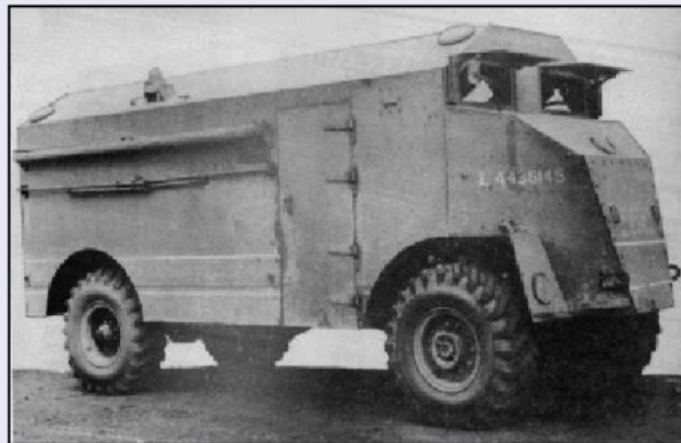
Een Guy Lizard ACV in de fabriek in Wolverhampton. Aan de zijkant zijn de opgerolde tent en de tentpalen bevestigd. De onderste foto toont het interieur van het voertuig
